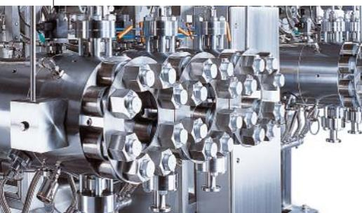
Продолжительный срок службы металлической мембранны достигается за счет равномерного распределения нагрузки на поверхности мембранны а также защиты материала мембранны от растяжения
