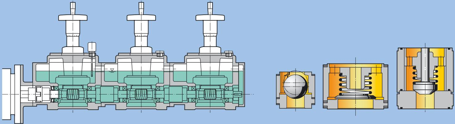
Общая масляная ванна. Многоголовочные насосы LEWA ecoflow не требуют дополнительных уплотнительных элементов вала при соединении нескольких редукторов.
