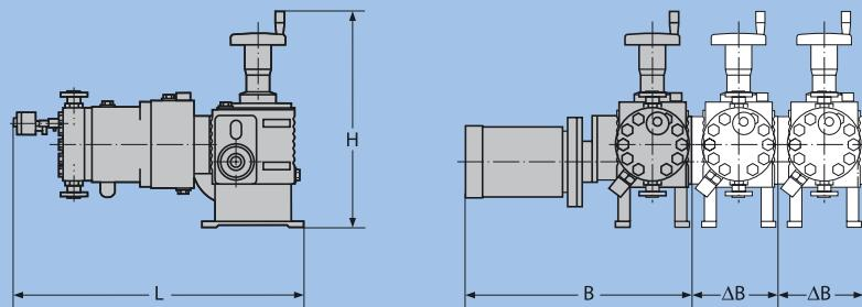
Размеры различаются в зависимости от устанавливаемой насосной головки
