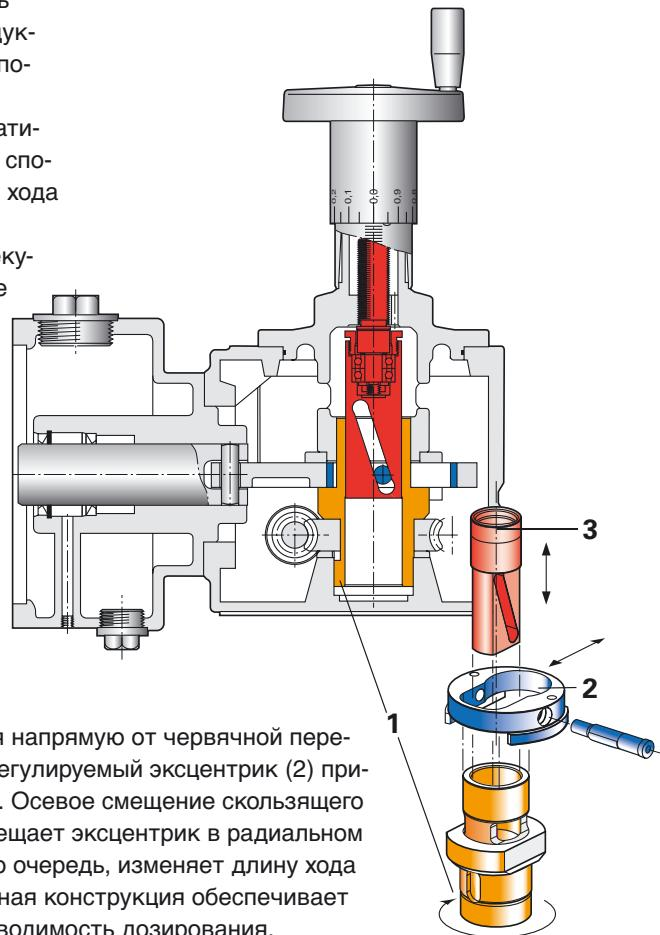
Движущий момент передается напрямую от червячной передачи через полый вал (1) на регулируемый эксцентрик (2) приводного механизма редуктора. Осевое смещение скользящего вала (3) с косым пазом перемещает эксцентрик в радиальном направлении. Который, в свою очередь, изменяет длину хода кривошипа. Простая и надежная конструкция обеспечивает высокую точность и воспроизводимость дозирования.
